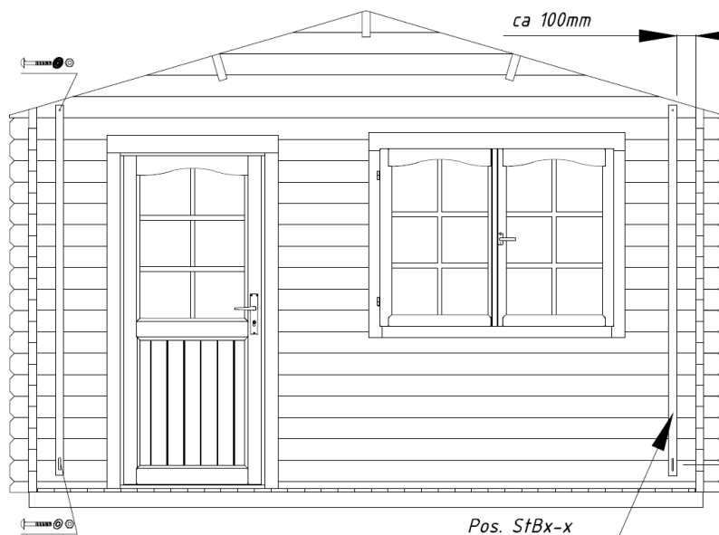
Montering av stormavstivere:
